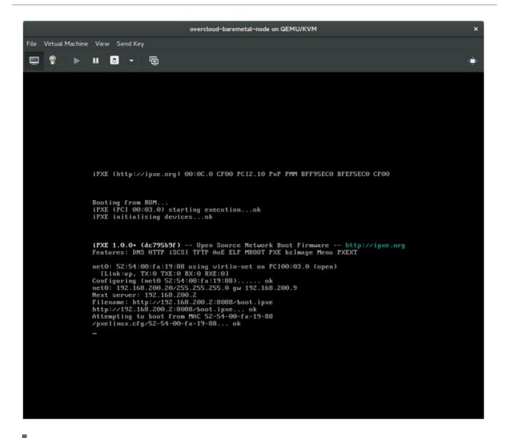
\$ grep ^pxe\_config\_template ironic.conf pxe\_config\_template=\$pybasedir/drivers/modules/ipxe\_config.template
