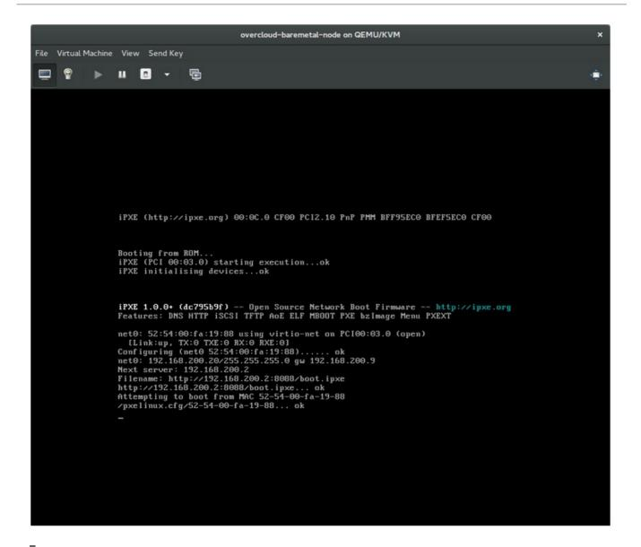
\$ grep ^pxe\_config\_template ironic.conf pxe\_config\_template=\$pybasedir/drivers/modules/ipxe\_config.template
