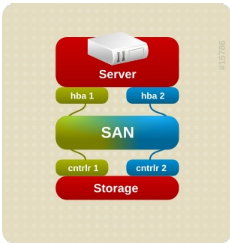
図1.3 RAID デバイスが1つのアクティブ/アクティブマルチパス設定
