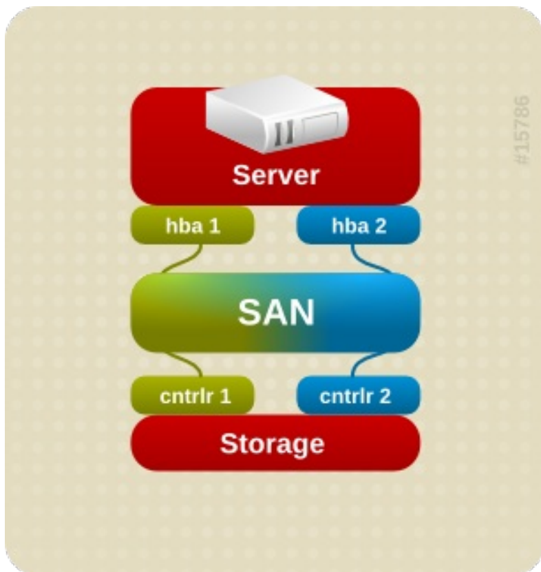
그림 1.3. Active/Active Multipath Configuration with One RAID Device
