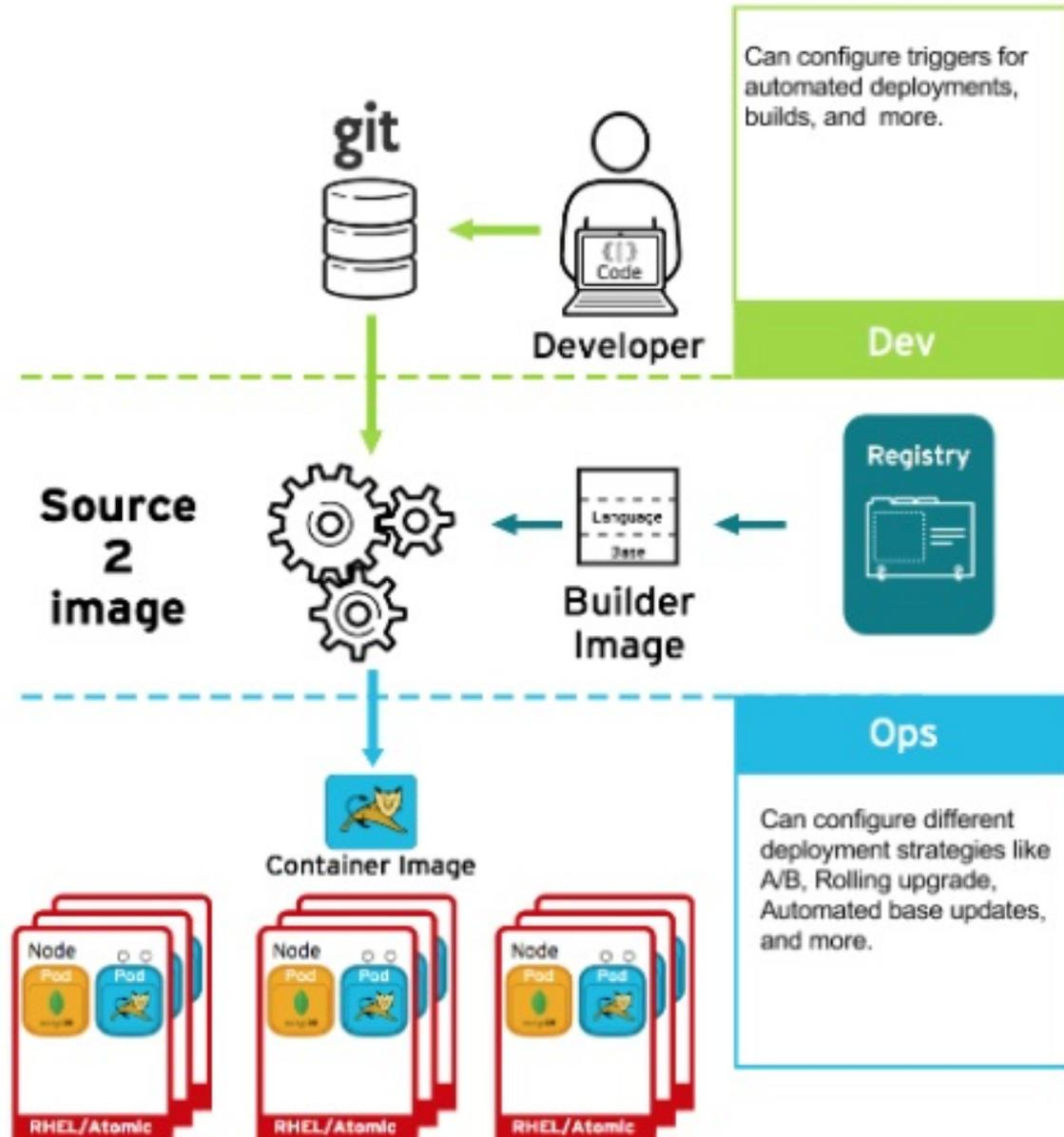
例如，您使用三个容器镜像层构建了一个应用程序：核心、中间件和应用程序。由于在核心镜像中发现了一个问题，该镜像被重建。构建完成后，镜像被推送到 OpenShift Container Registry。OpenShift Container Platform 检测到镜像已更改，并根据定义的触发器自动重建并部署应用程序镜像。这一更改包含了固定的库，并确保产品代码与最新镜像是一致的。
