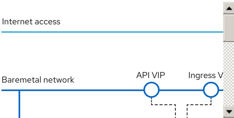
当完成 OpenShift Container Platform control plane 节点安装并可以正常工作时，安装程序会自动销毁 bootstrap 虚拟机，并相应地将虚拟 IP 地址（VIP）移到适当的节点。API VIP 移至 control plane 节点，Ingress VIP 移至 worker 节点。
