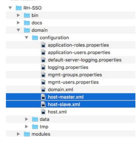
要禁用负载均衡器服务器实例,请编辑 host-master.xml 并注释掉或删除 "load-balancer" 条目。
